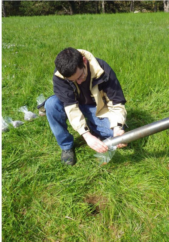
**Photo 2 : Réalisation d'une mesure radiométrique sur le prélèvement d'herbe**
